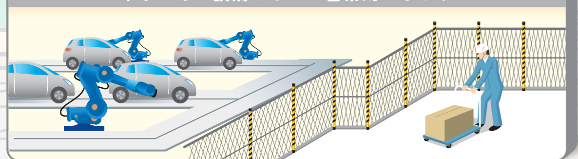
自動車産業中心に大型の製造工場で使用。安全柵でヒトとロボットを分離する必要あり。 ※上記はイメージ図です。
